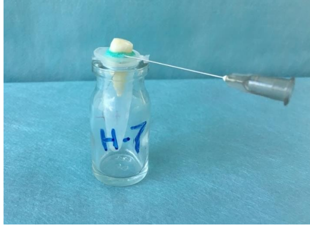
Şekil 3.3. Taşan debrisin toplanması için kurulan deney düzeneği
