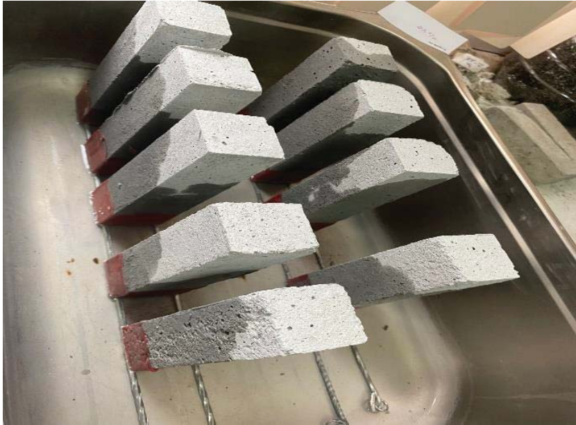
Şekil 3.8. Kılcal su emme tayini deneyi düzeneği
