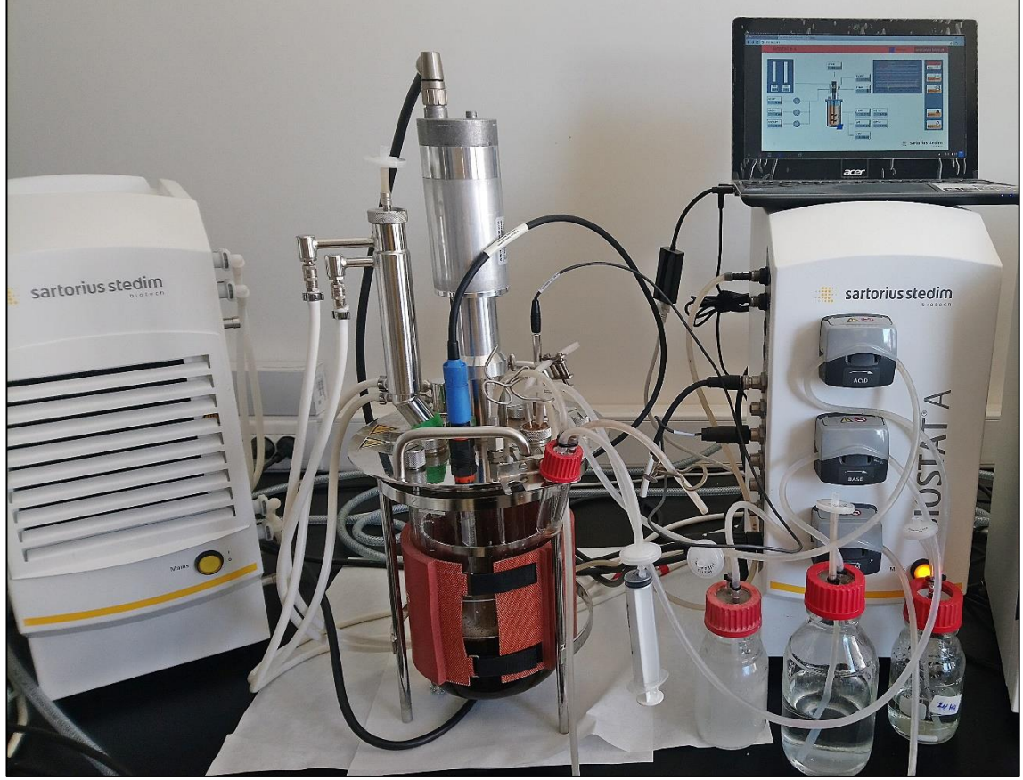
Şekil 4.18. Biyoreaktörde gerçekleştirilen HA üretim fermentasyonlarına ait görüntü
