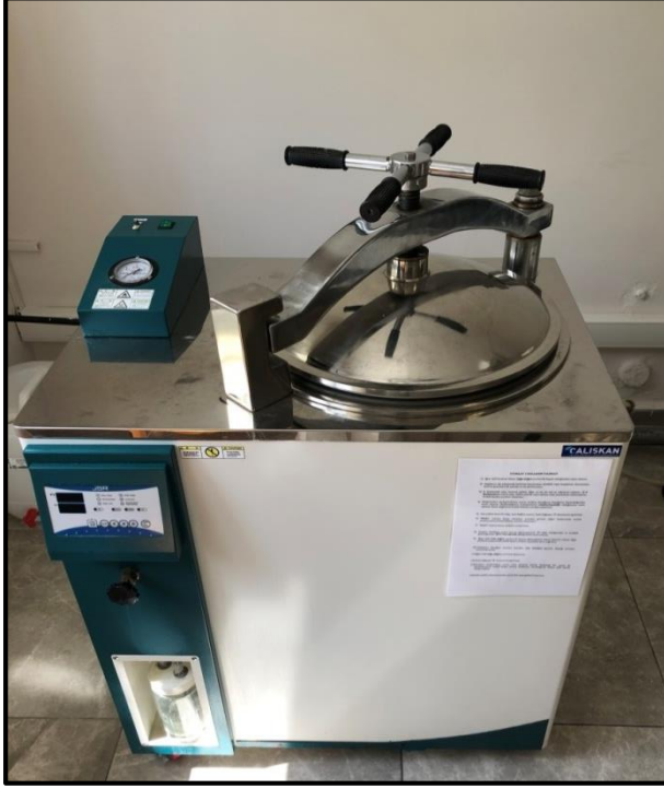
Şekil 3.1. Sterilizasyon işlemlerinin gerçekleştiği otoklav
