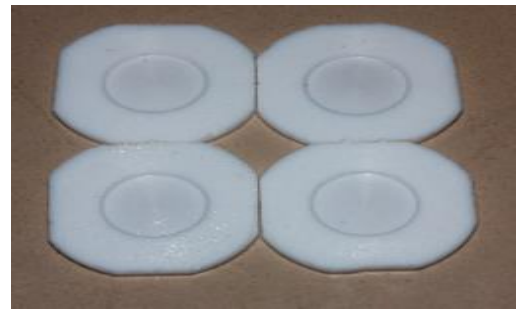
Şekil 3.4. Su emme ve çözünürlük test numuneleri hazırlanmak için kullanılan kalıplara ait model ve fotoğraf
