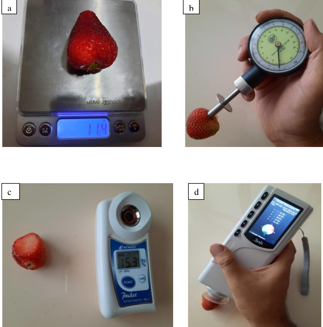
Şekil 3.6. Meyvelerde yapılan pomolojik analizlerden genel görünüm. Meyve ağırlığı (a); Meyve Et Sertliği (b); Suda Çözünebilir Kuru Madde (c); Renk Ölçümü (d)
