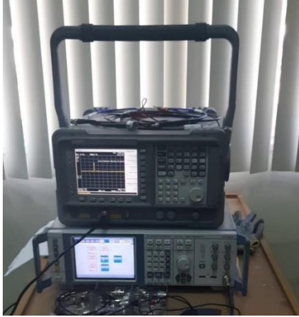
Şekil 3.8. Ölçümde kullanılan spektrum analizör ve RF işaret üretici
