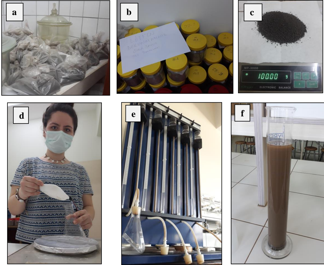
Şekil 3.4. Fizikokimyasal analiz aşamaları; a) Çalışmada kullanılan toprak örneklerin laboratuvara gelmesi; b) Toprakların hava kuru duruma gelen ve elenen toprakların kavanozlara aktarılması; c) pH, EC, Kireç vb. analizler için gerekli olan tartım aşaması; d) Kimyasalların ve toprakların tartımı; e) Kalsimetre ile kireç ölçümü; f) Mezür içerisinde bulunun toprakların tekstür sınıfının belirlenmesi
