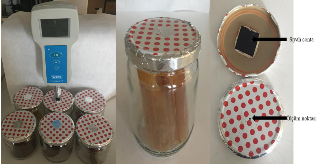
Şekil 3.2. Oksijen tutma kapasitesi ölçümü için kullanılan sistem
