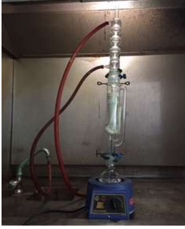
Şekil 3.5. Çalışmada kullanılan Sokset ekstraksiyonu deney düzeneği
