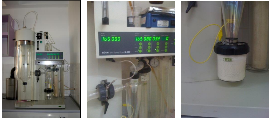
Şekil 3. 5. Püskürterek kurutma sisteminde çöven tozu üretimi
