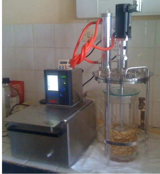
Şekil 3. 2. Denemelerde kullanılan ekstraksiyon düzeneği
