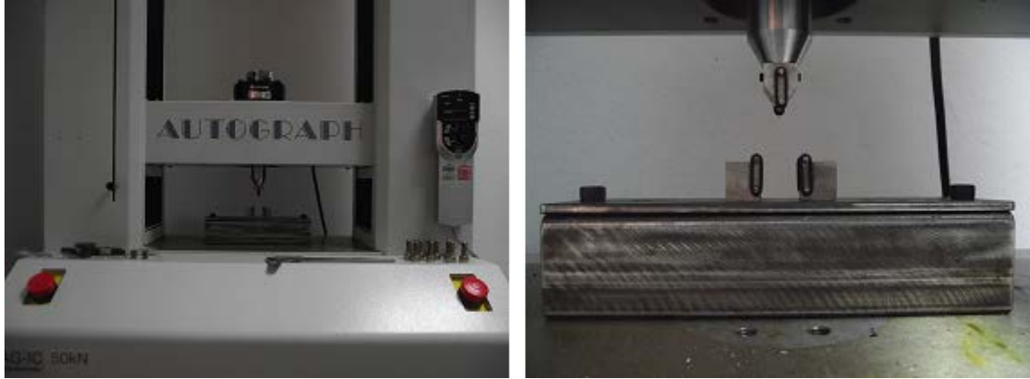
Şekil 3.12 Shimadzu AG-IJ Autograph (50 kN) test cihazı ve üç nokta eğme testi aparatı
