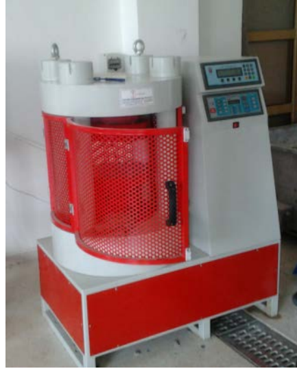
Şekil 3.4 Beton test presisi 2000kN
