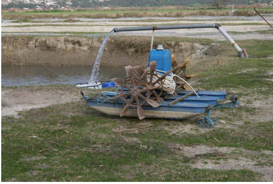
Şekil 4.9. Havuzları yüzeyden havalandırmaya yarayan aeratör
