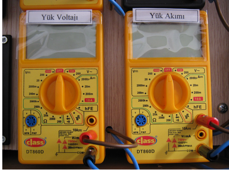
Şekil 3.23. Multimetre (Volt ve Amper ölçer)
