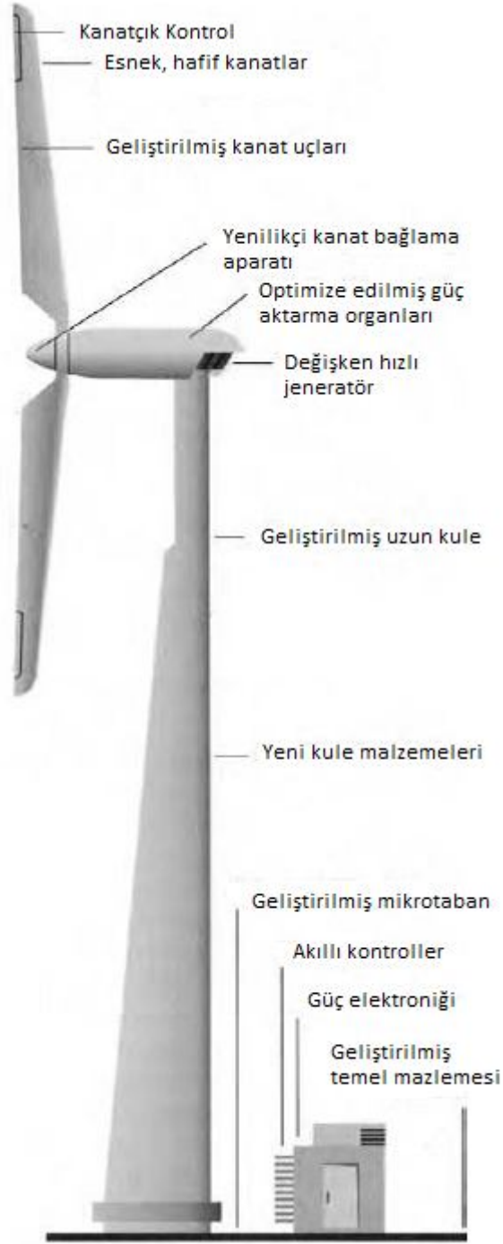
Şekil 2.1. Yeni nesil bir rüzgar türbinin şematik resmi (Patel 2005)
