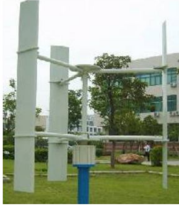
Şekil 2.6. Giromill veya H-rotor rüzgar türbini (Jorgensen ve Nielsen 2008)
