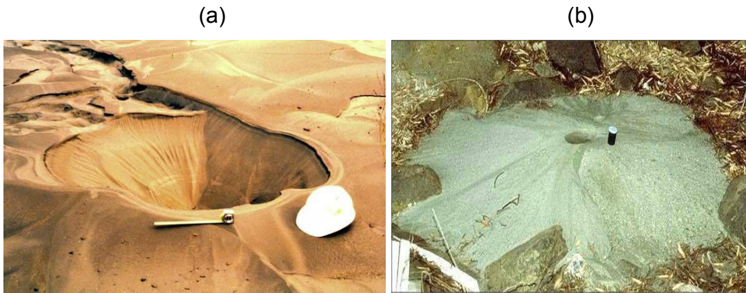
Şekil 2.5. Loma Prieta (ABD) depreminde gözlenen (a) Kum konisi ve (b) Kum volkanı (www.ce.washington.edu)
