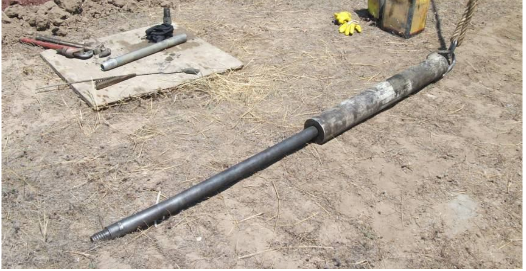
Şekil 3.4. SPT deneyinde kullanılan güvenli (safety) şahmerdan
