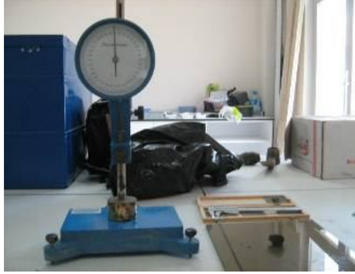
Şekil 3.10. Koni penetrometre yöntemiyle likit limit deneyi
