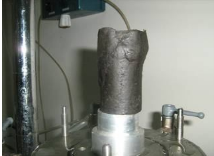
Şekil 3.13. Üç eksenli basınç deney sonucu yenilen koyu gri kil numunesi
