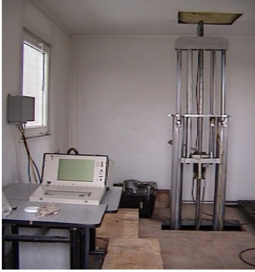
Şekil 3.5. Çalışmada kullanılan CPT makinası ve veri toplama sistemi
