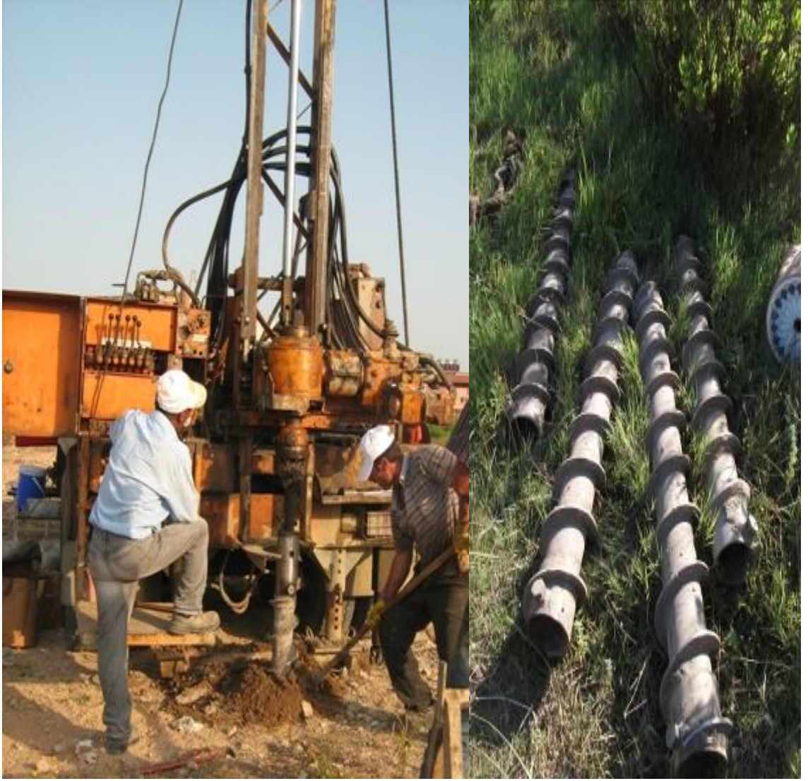
Şekil 3.2. Çalışmada kullanılan sondaj makinesi ve augerler
