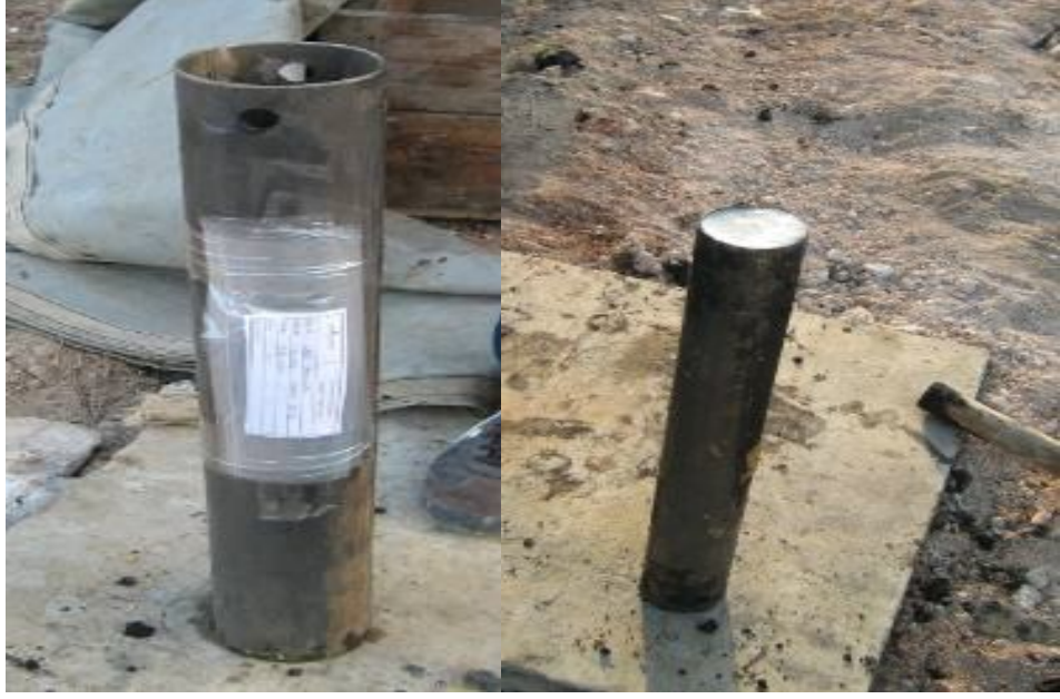
Şekil 3.3. Örselenmemiş numune alımında kullanılan shelby tüpler
