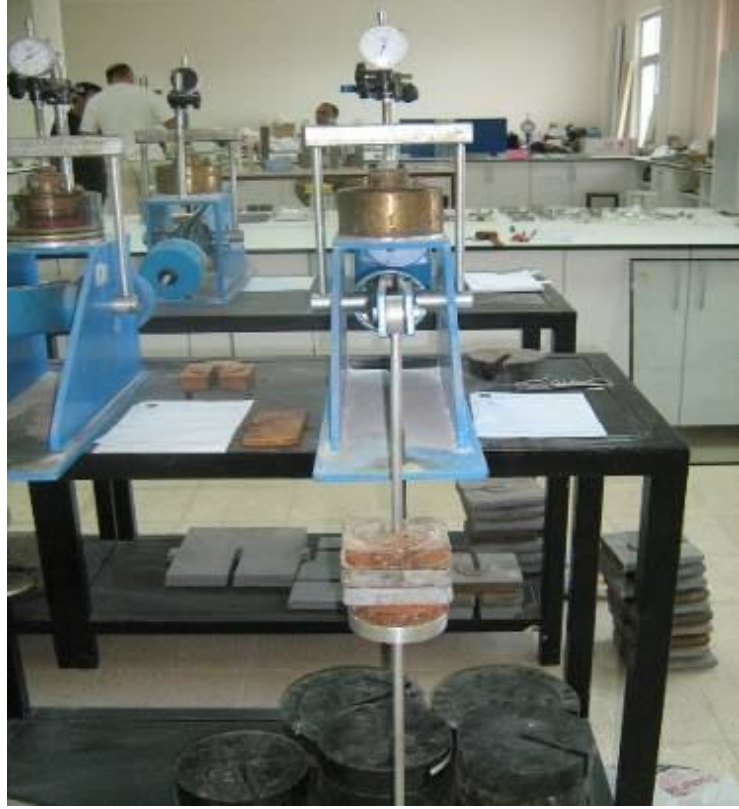
Şekil 3.14. Ödometre deney düzeneği
