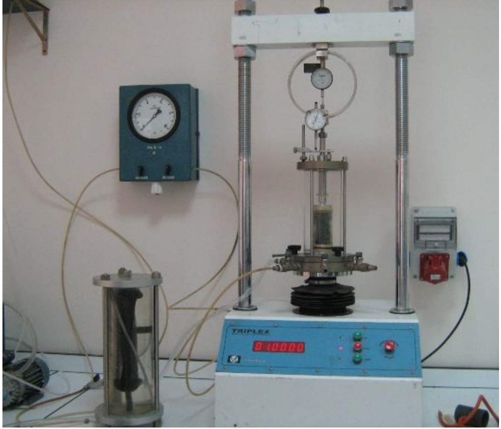
Şekil 3.12. Üç eksenli basınç deney düzeneği
