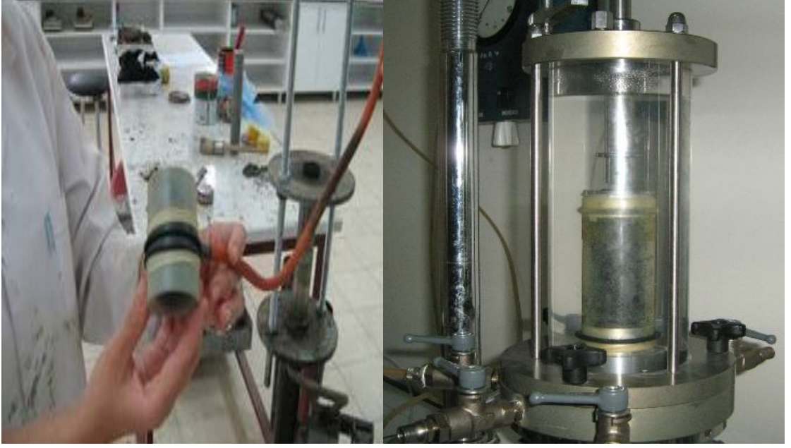
Şekil 3.11. Numunenin çevresine geçirilen lastik kılıf
