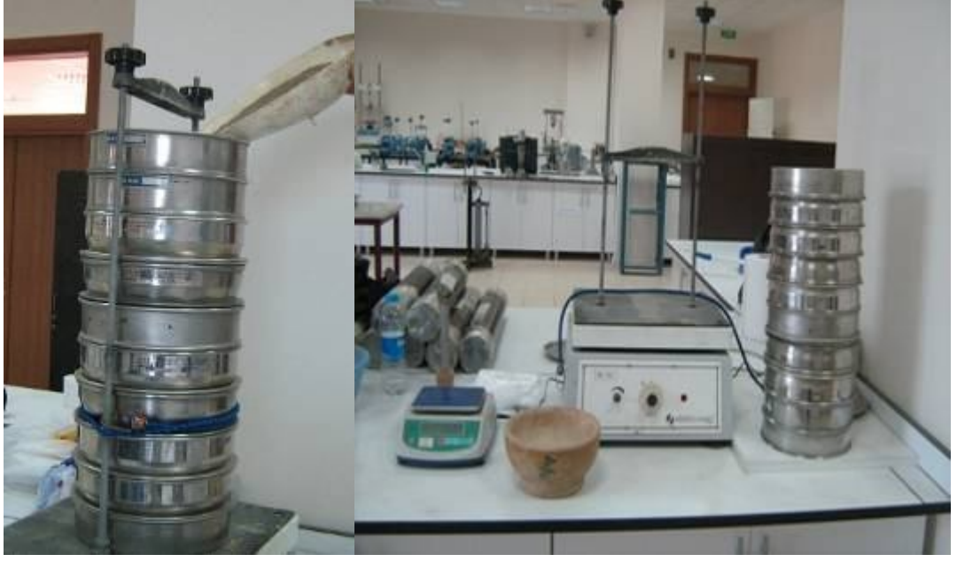
Şekil 3.7. Elek analizi ekipmanları
