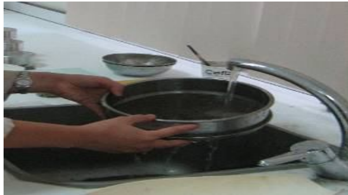
Şekil 3.8. Islak elek analizi yapılışı
