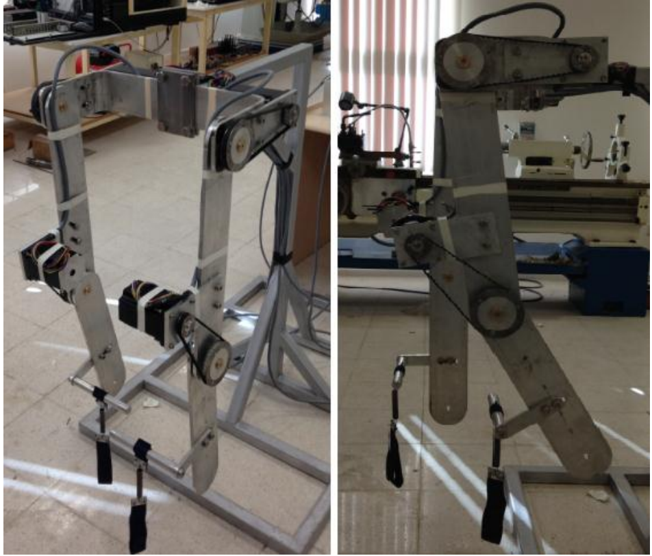
Şekil 4.16. Dış iskeletin montajının tamamlanmış hali
