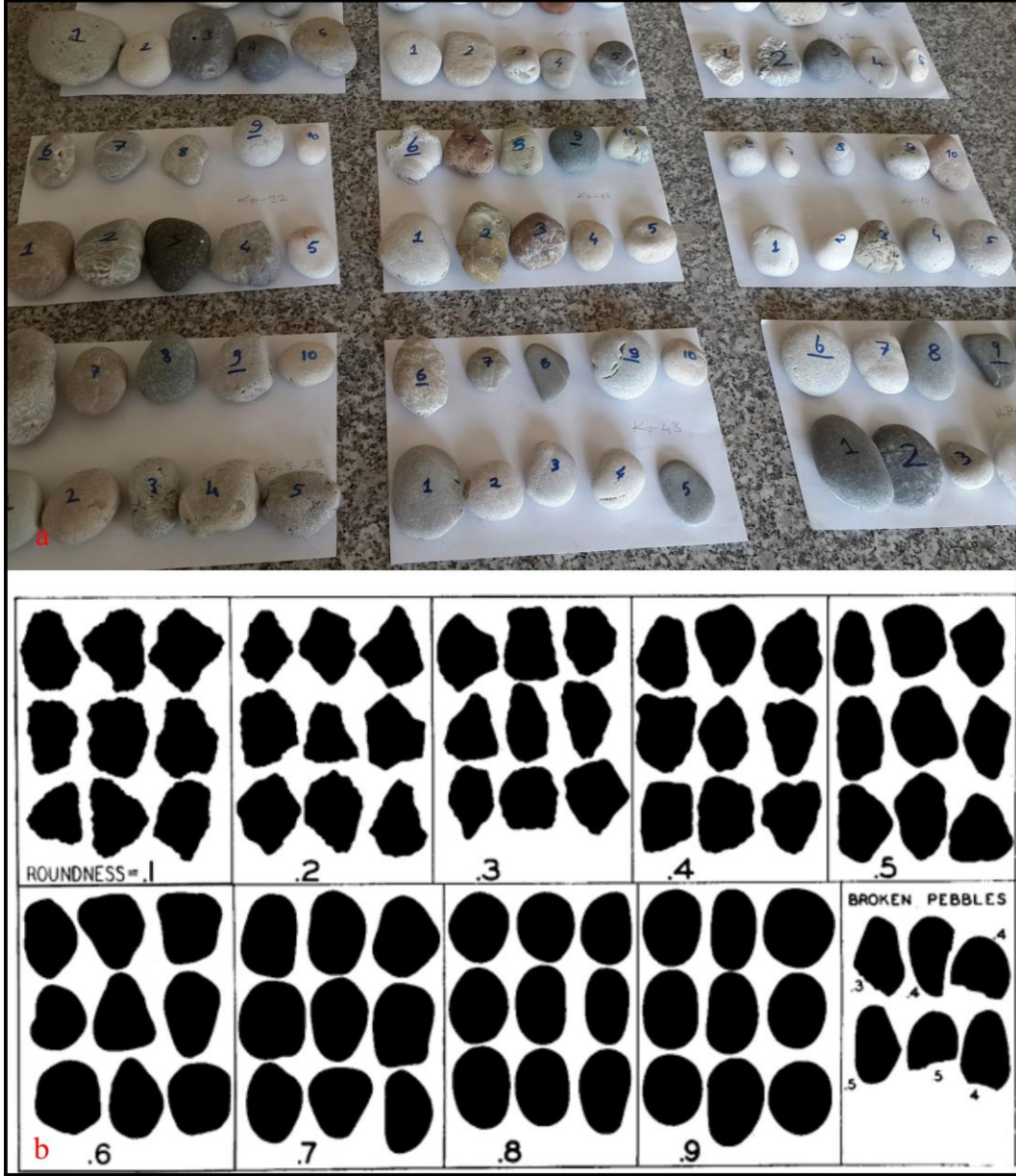
Şekil 4.8. Kompas ile ölçüm alınan çakıllar
