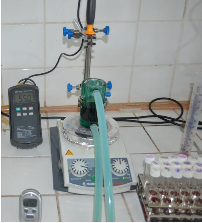
Şekil 3.3. Pastörizasyon işlemlerinin gerçekleştirildiği çift cidarlı beher
