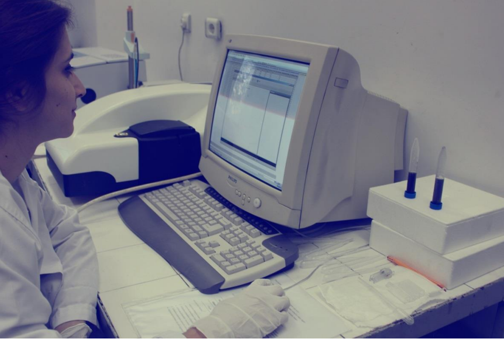
Şekil.3.2. Malvern Zetasizer Nano-ZS model cihaz ile zeta potansiyel ölçümü
