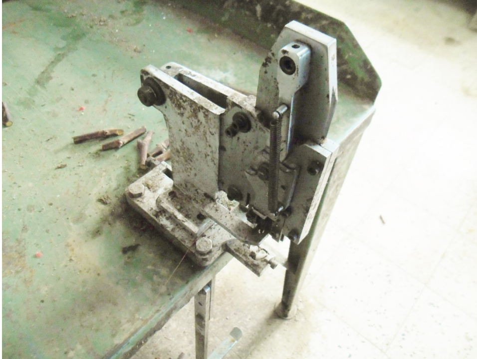
Şekil 2.11. Anaç ve kalemleri birleştirmekte kullanılan omega aşı makinesi (Bu çalışmadan. Manisa Bağcılık Araştırma İstasyonu)
