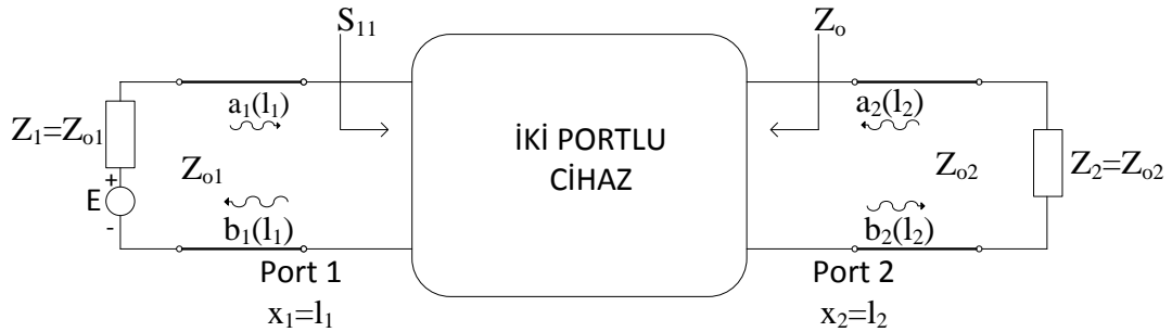
Şekil 3.6. S-parametresi ölçümünde iletim hattındaki karakteristik empedansların gösterimi (Gonzalez 1996)
