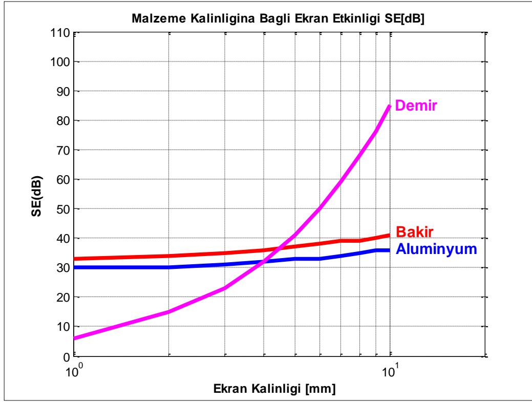
Şekil 3.7. Demir, Bakır ve Alüminyum için deri kalınlığı etkisi
