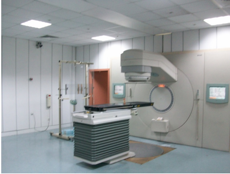
Şekil 3.1. Bu çalışmada kullanılan Philips (Elekta TM Synergy) SLI-25 marka klinik elektron lineer hızlandırıcı ( http://nukleer.akdeniz.edu.tr/clinac-6ce )
