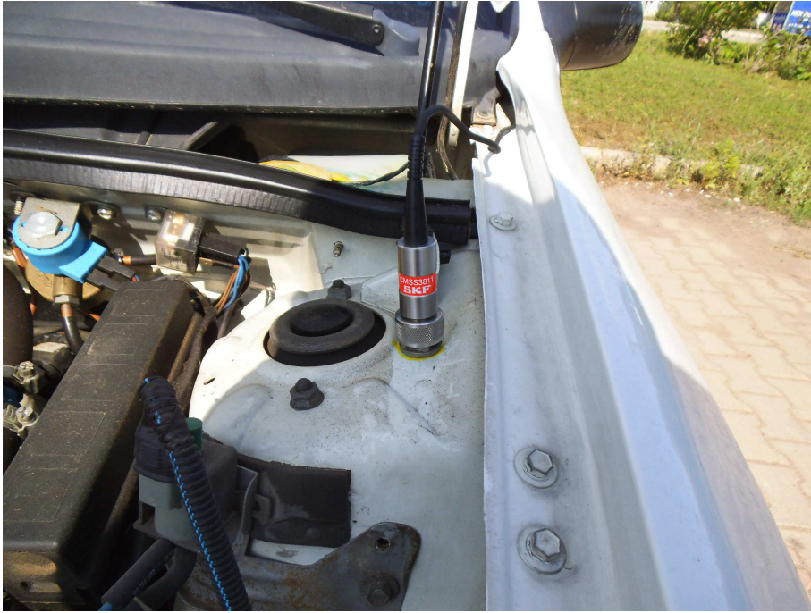
Şekil 4.13. Sol ön süspansiyon kulesine düşey olarak bağlanan ivmeölçer
