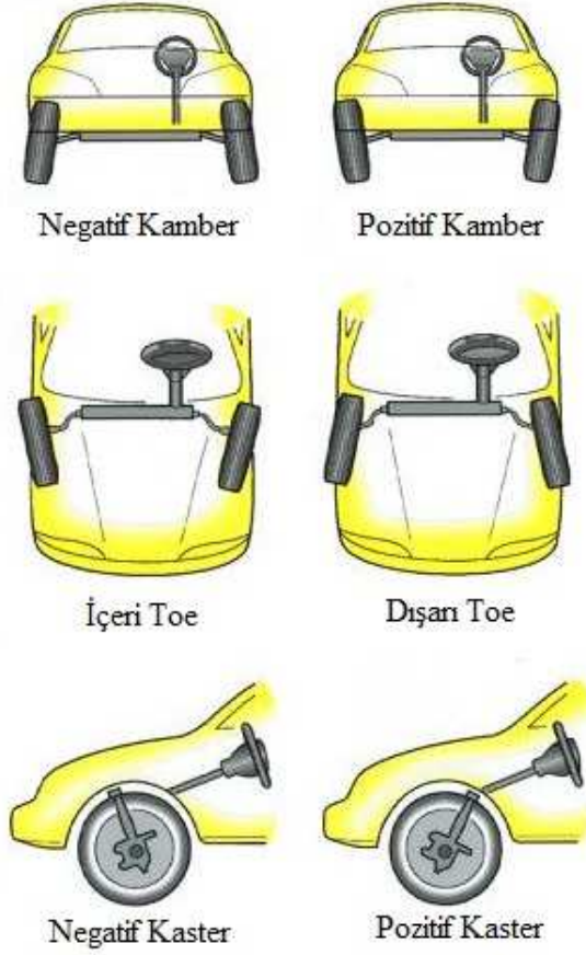
Şekil 2.11. Birtakım değişkenler tarafından kalibre edilen ön süspansiyon geometrisi
