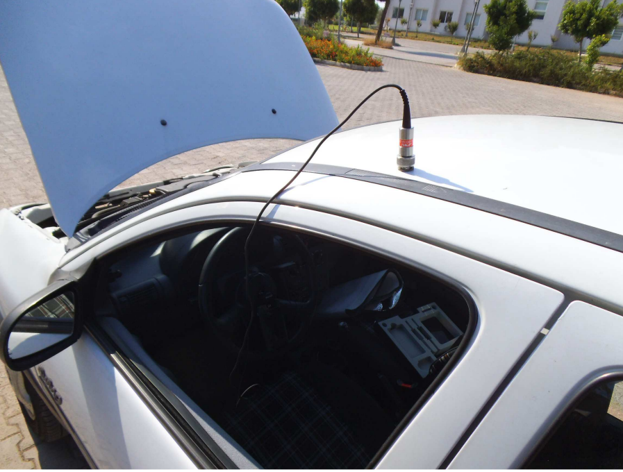
Şekil 4.15. İvmeölçerin sürücü tarafı tavana düşey olarak bağlanması
