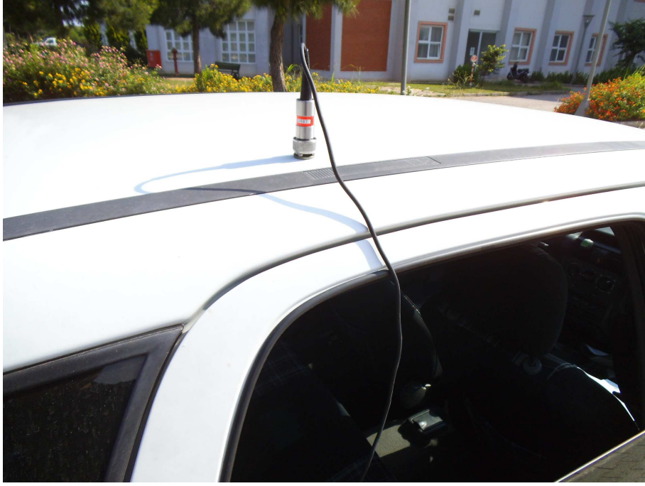
Şekil 4.16. İvmeölçerin sağ arka yolcu tarafı tavana düşey olarak bağlanması
