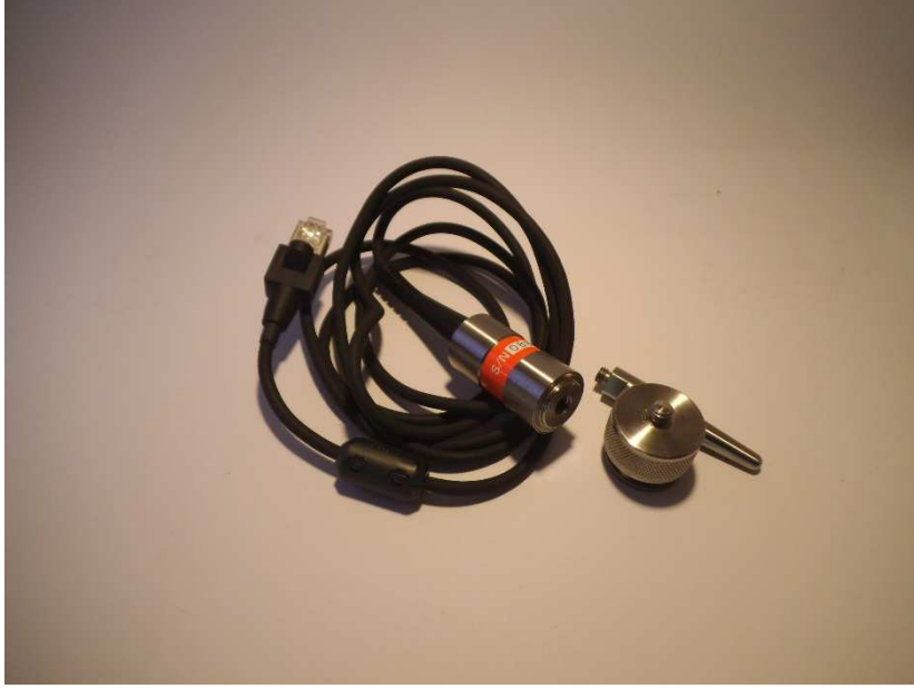
Şekil 3.12. 0.3 m kablo ve bağlantı aparatlarıyla ivmeölçer
