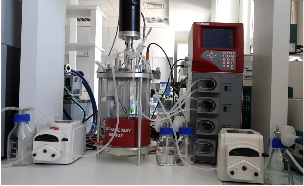
Şekil 3.10. Dinamik in vitro gastrointestinal modelin ince bağırsak kısmı
