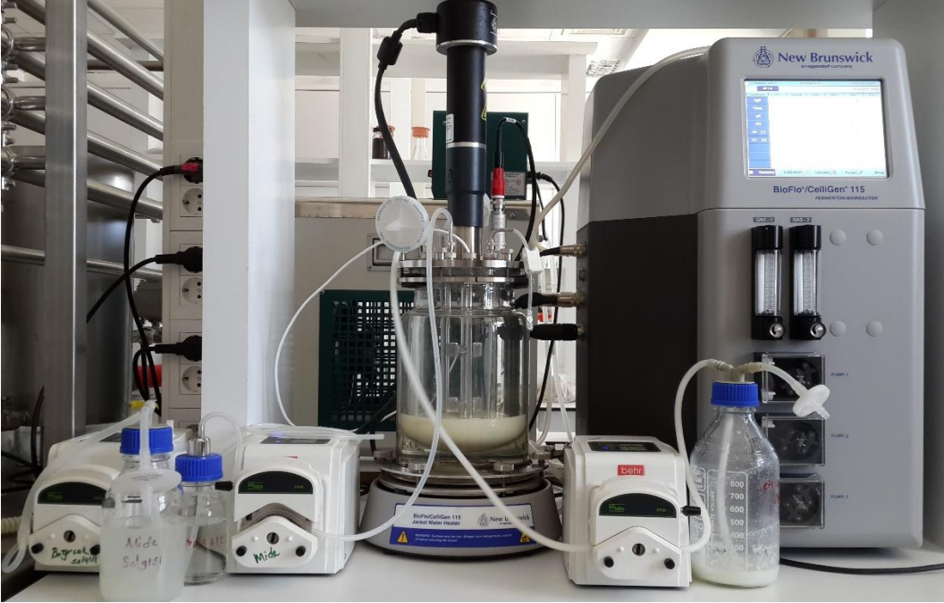
Şekil 3.9. Dinamik in vitro gastrointestinal modelin mide kısmı
