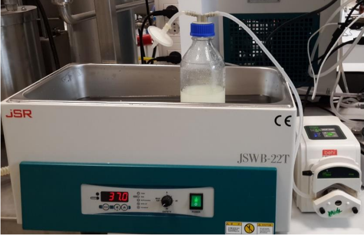
Şekil 3.8. Dinamik in vitro gastrointestinal modelin ağız kısmı
