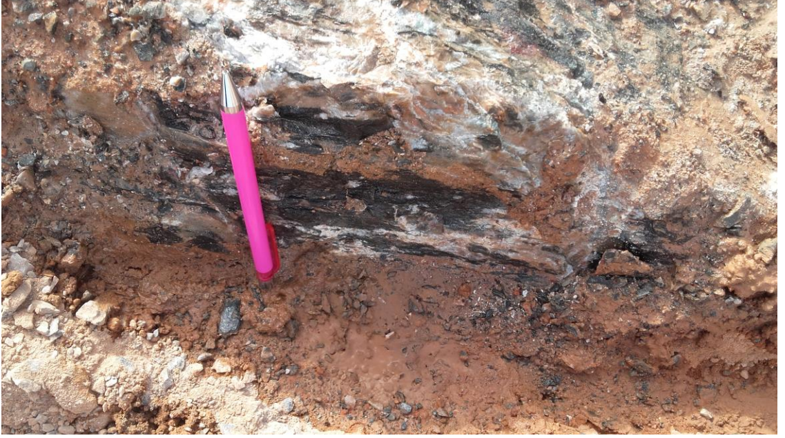
Şekil 5.4. Siyah kumtaşları üzerinde ölçülmüş şistozite, MZ4 bölgesinden
