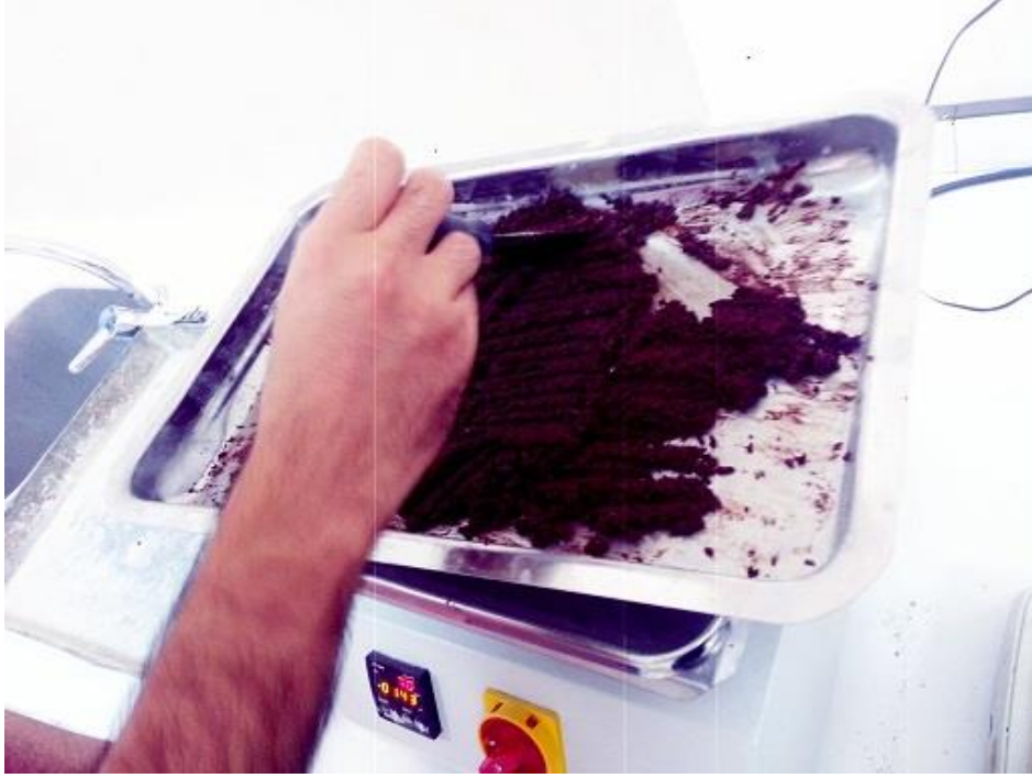
Şekil 3.2. Isıtıcı plaka cihazı ile 60 °C de agregayı SDYK hale getirme
