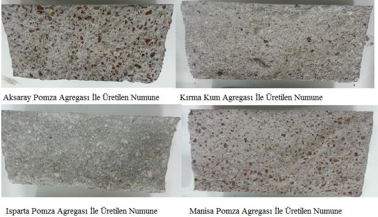
Şekil 3.8. Yarmada çekme dayanım tayini ve kırılan numuneler
