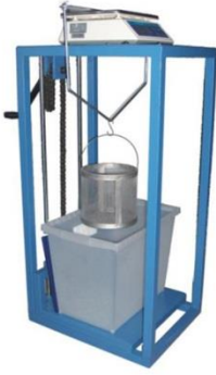
Şekil 3.4 Sertleşmiş ÇBM'de Özgül Ağırlık Deney Düzeneği
