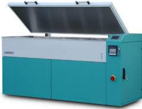
Şekil 3.9. Donma çözünme deneylerinin yapıldığı düzenek
