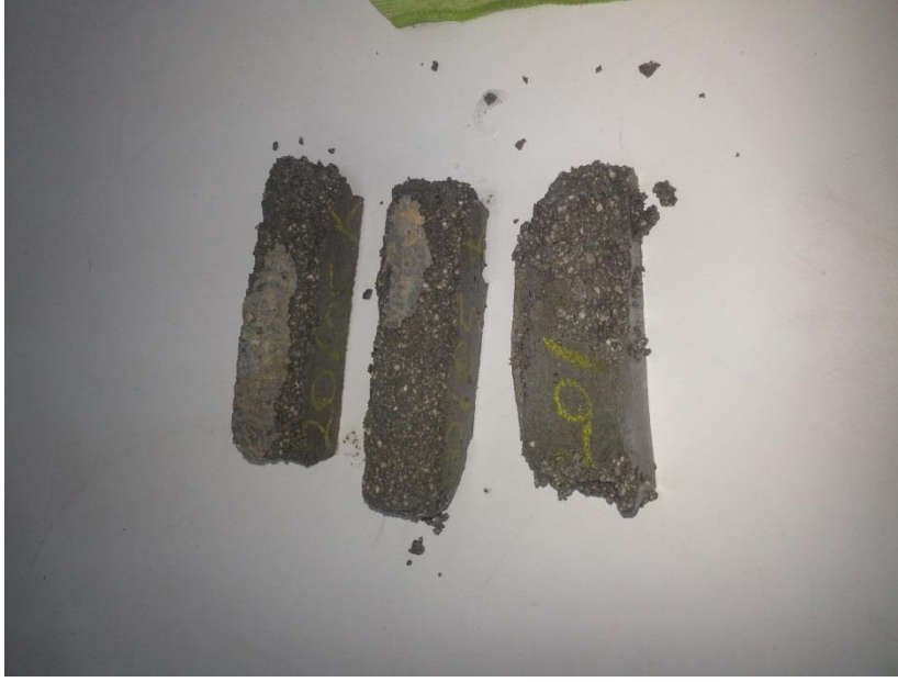
Şekil 5.9. Normal agregalı 28 günlük 30 çevrime maruz kalmış numunelerin dağılması
