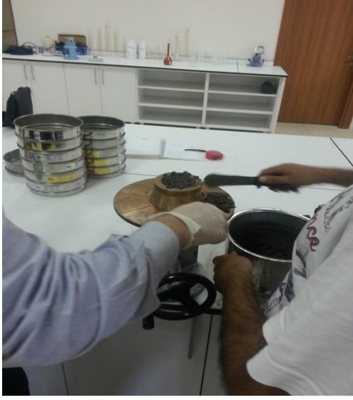
Şekil 3.3. Taze halde ki karışımın yayılma tablası deneyi
