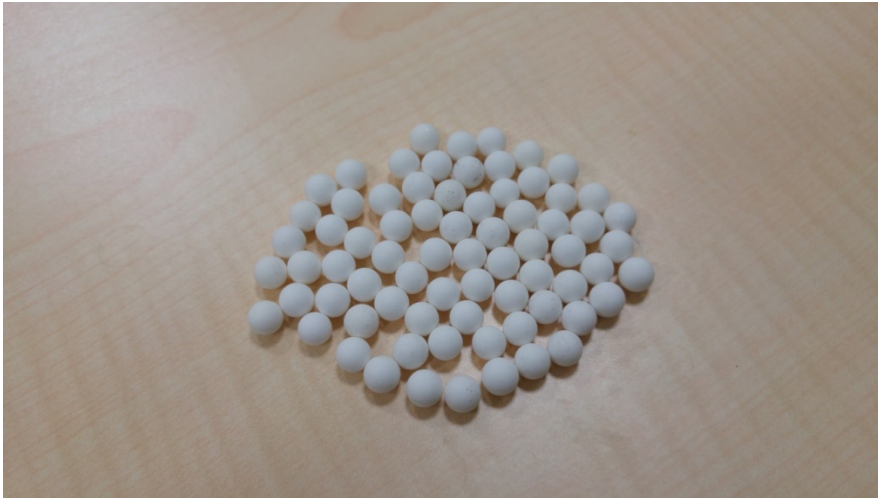
Şekil 3.18. Bakır boru içerisine yerleştirilen seramik bilyeler
