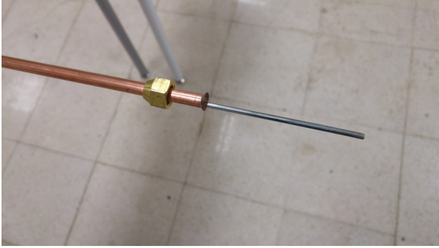
Şekil 3.17. Bakır borunun içerisine düz çubuğun yerleştirilmesi
