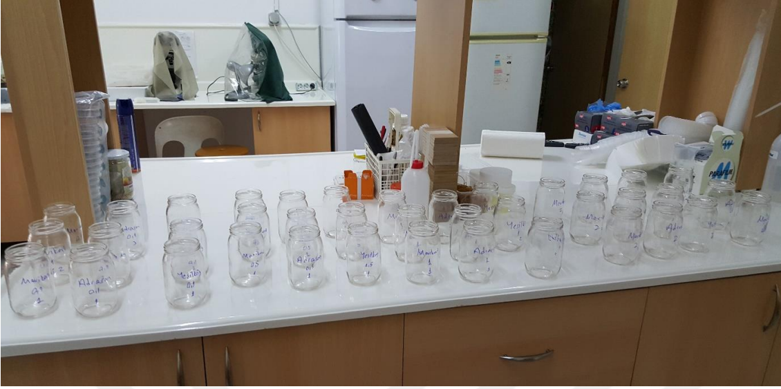
Şekil 3.12. İç yüzeylerine asetonla birlikte deltamethrin uygulanan kavonozların kurutulması
