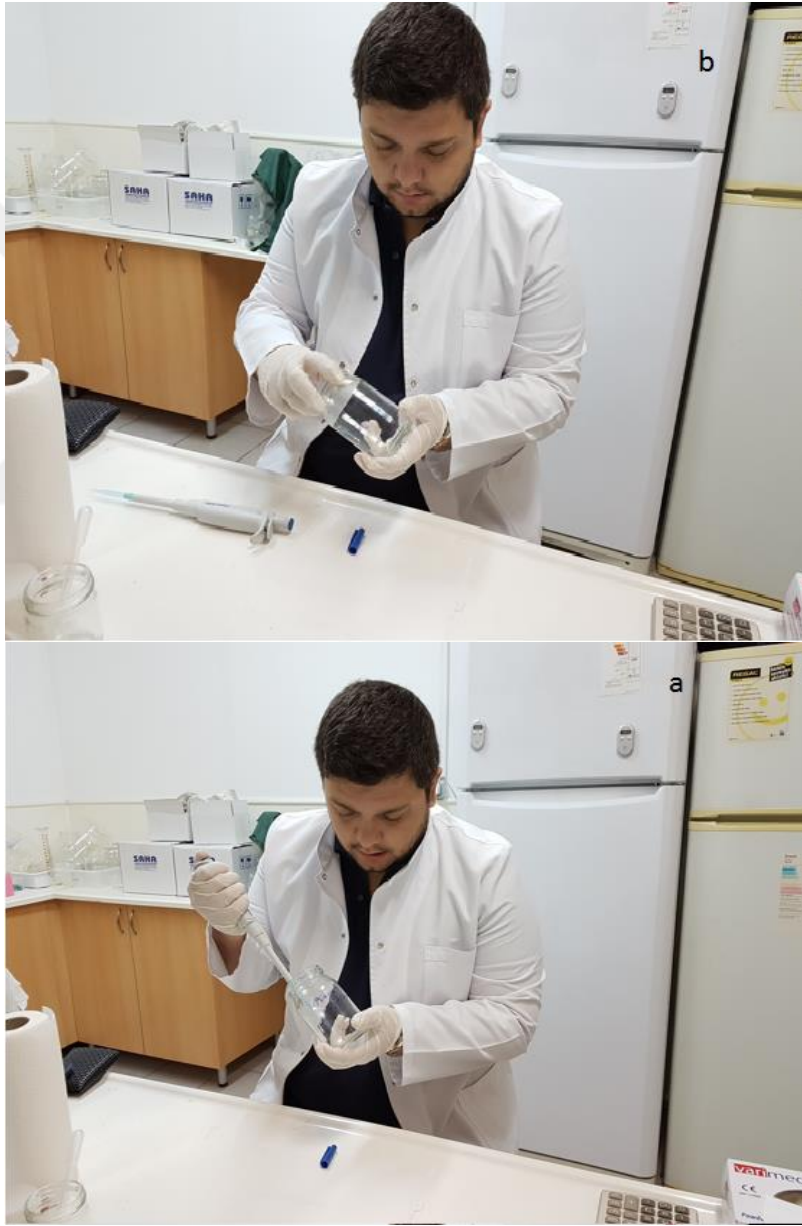
Şekil 3.11. Laboratuvarda kavanozlara (a) deltamethrin ile asetonun uygulanması ve (b) kavanoz içine yayma işleminin yapılması
