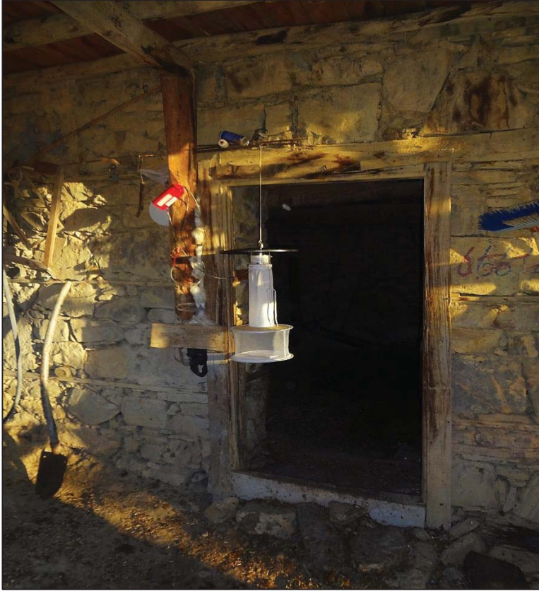
Şekil 3.3. Ahır girişine kurulmuş ışık tuzağı
