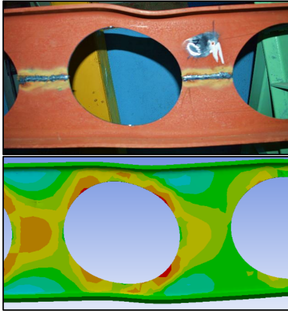
Şekil 4.139. IPE_DB_240 kirişleri deneysel ve SEA görsel olarak karşılaştırılması
