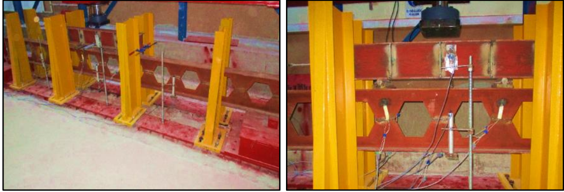
Şekil 4.66. IPE_PB_300; petek boşluklu kiriş deneyi; iki noktadan yükleme
