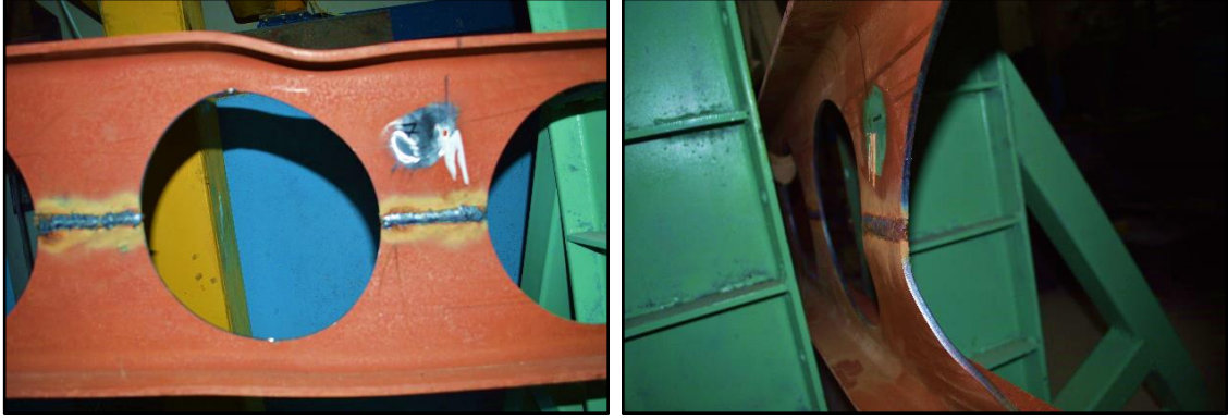
Şekil 4.50. IPE_DB_240_Test_2; yayılı yükleme altında göçme durumu
