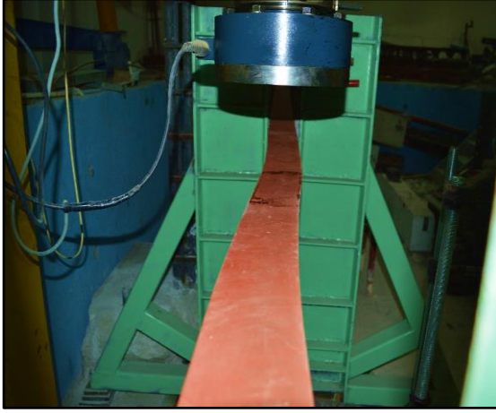
Şekil 4.5. IPE_SB_200_Test_2; tekil yükleme altında yanal burkulma durumu
