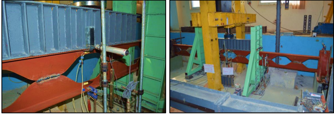
Şekil 4.30. IPE_SB_240 sinüsoidal boşluklu kiriş deneyi; yayılı yükleme durumu
