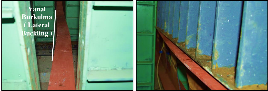
Şekil 4.40. IPE_PB_240_Test_1; yayılı yükleme altında göçme durumu
