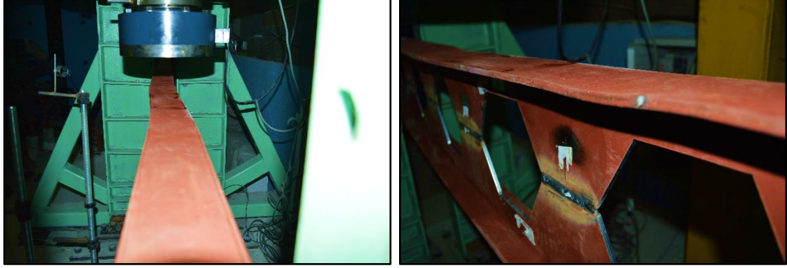
Şekil 4.13. IPE_PB_200_Test_2; yanal burkulma ve yerel burkulma durumu
