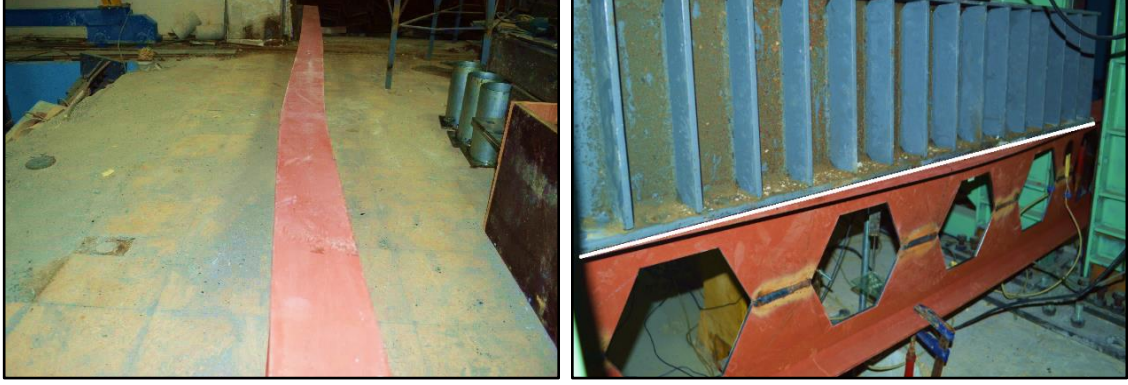
Şekil 4.42. IPE_PB_240_Test_2; yayılı yükleme altında göçme durumu
