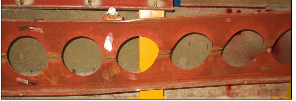
Şekil 4.78. IPE_DB_300_Test_2; iki noktadan yükleme altında göçme durumu
