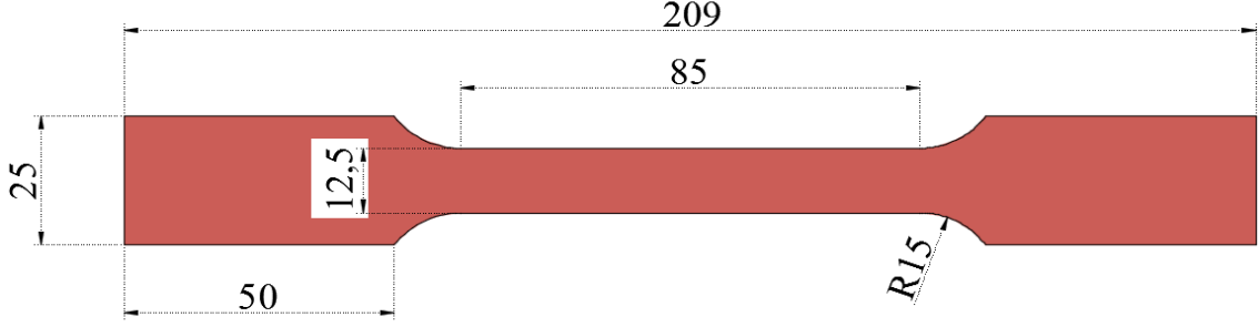
Şekil 3.23. IPE_200_240_300 profillerden alınan numunelerin boyutları
