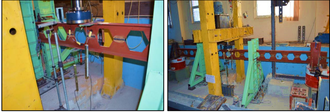
Şekil 4.9. Petek boşluklu kiriş testi; tekil yüklenme durumu
