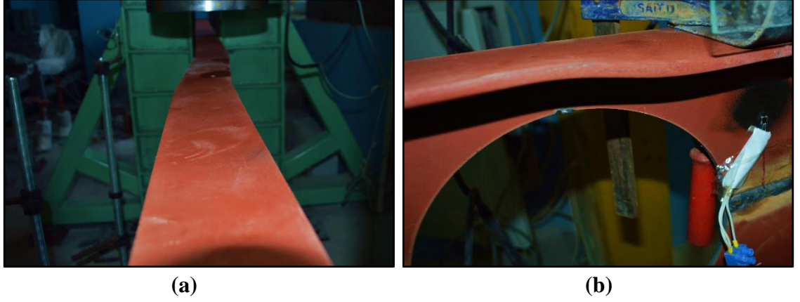
Şekil 4.21. IPE_DB_200_Test_2; a) Yanal burkulma b) Yerel burkulma
