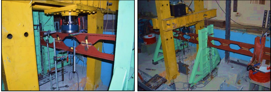
Şekil 4.1. Sinüsoidal boşluklu kiriş testi; tekil yüklenme durumu
