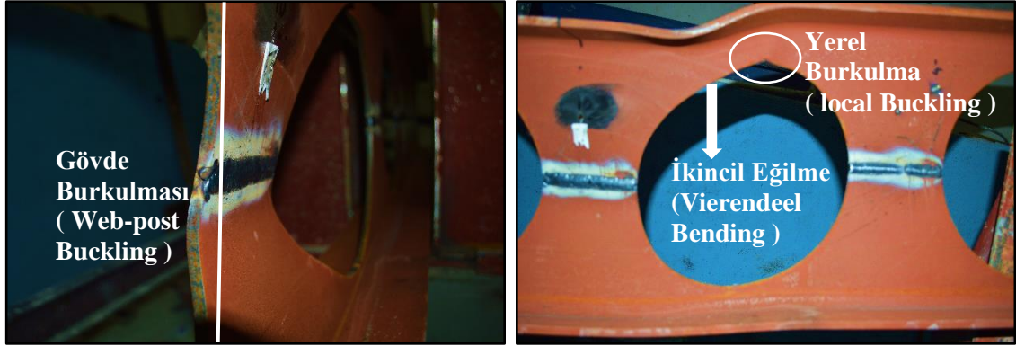
Şekil 4.48. IPE_DB_240_Test_1; yayılı yük altında göçme durumu
