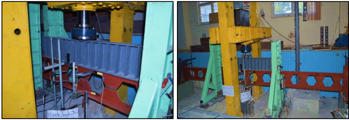
Şekil 4.38. IPE_PB_240; petek boşluklu kiriş deneyi; yayılı yükleme durumu
