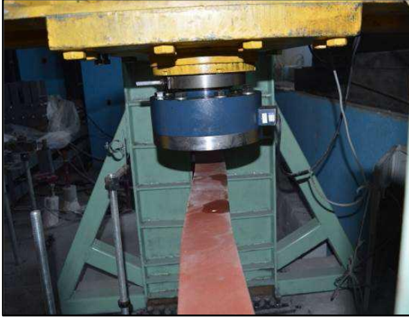
Şekil 4.3. IPE_SB_200_Test_1; tekil yükleme altında yanal burkulma durumu
