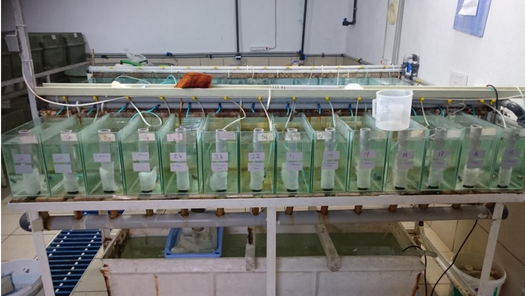
Şekil 3.1.T.C. Gıda Tarım ve Hayvancılık Bakanlığı Akdeniz Su Ürünleri Eğitim Araştırma ve Üretim Tesisi Akvaryum Bölümü'ndeki deneme ünitesindeki kapalı devre sistem
