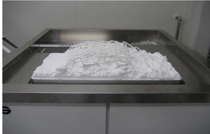
Şekil 13: SLS tipi 3B yazıcı ile toz poliamid materyal içinde oluşturulmuş obje.
