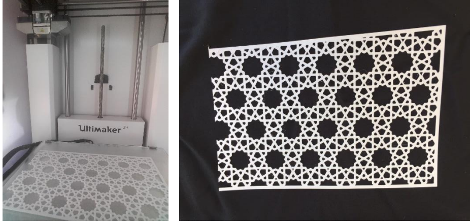
Şekil 53: Ultimaker 2+ 3B yazıcıda TPU ile basılmış 0.5 mm kalınlığında yüzey
