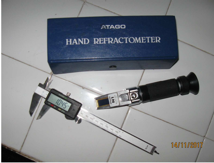
Şekil 3.11. Analizlerde kullanılan refraktometre ve dijital kumpas
