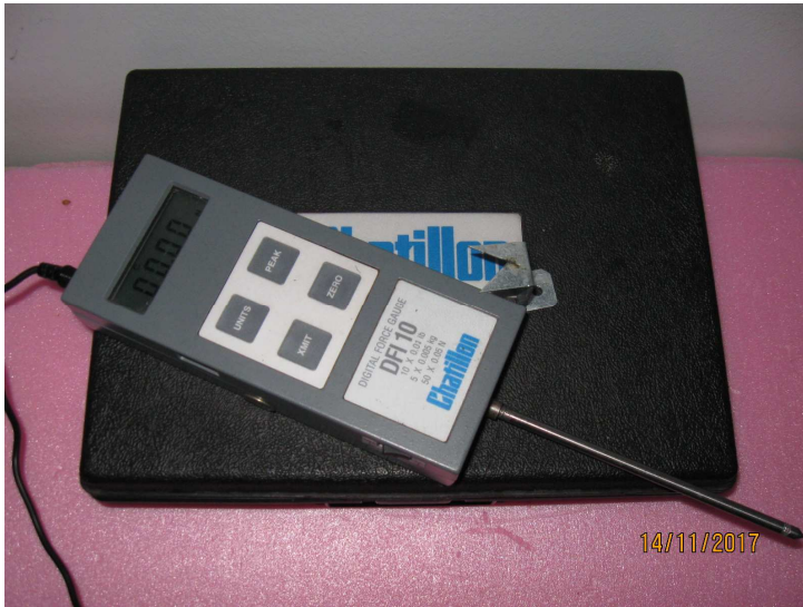
Şekil 3.13. Analizlerde kullanılan dijital dinamometre ve ölçüm uçları
