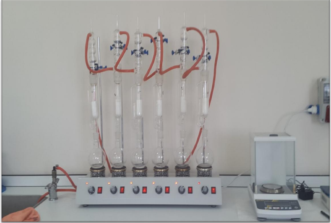
Şekil 3.5. Yağ-gres analizi ısıtma sistemi
