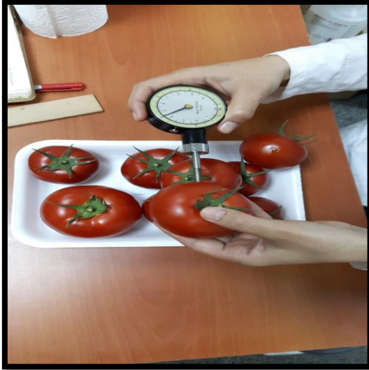
Resim 3.29. Meyve eti sertliğinin ölçüldüğü penetrometre ve ölçümün yapılmasından genel bir görünüm
