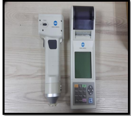
Resim 3.26. b) Meyvelerin renk ölçümünün yapıldığı kromametre
