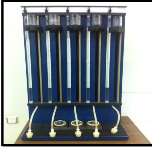
Resim 3.18. Kalsimetre ve kireç ölçümünden genel bir görünüm
