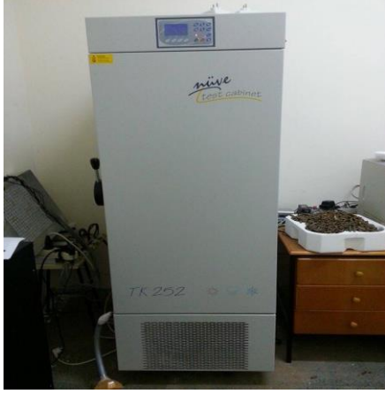
Şekil 3.9. İklimlendirme test kabini
