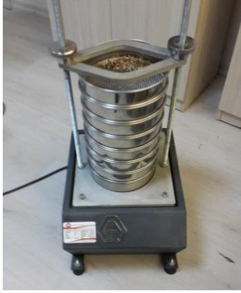
Şekil 3.6. Materyallerin parçacık boyut dağılımlarının belirlendiği elek analiz seti
