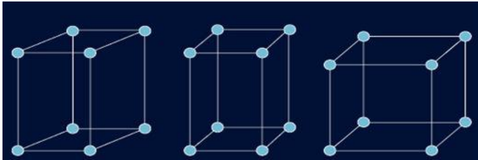
Şekil 2.3.2.1: Zirkonyanın m-t-k fazdaki kristal yapıları.(85)
