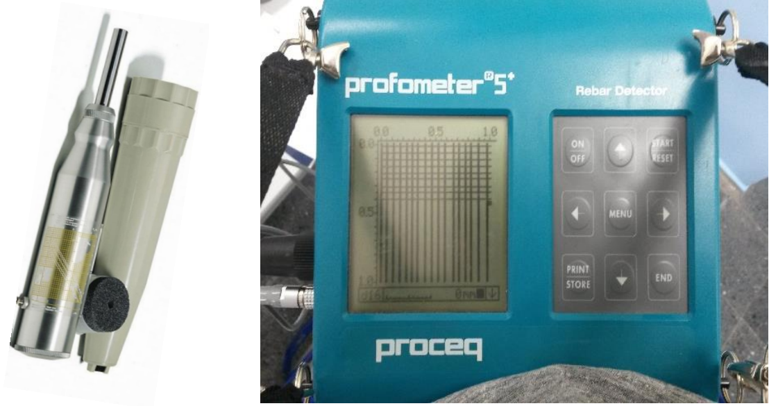
Şekil 3.1. Çalışmada kullanılan beton test çekici ve donatı tespit cihazı
