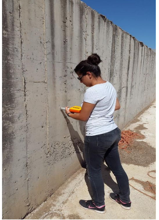
Şekil 4.1. Beton test çekicinin yapı elemanına uygulanması
