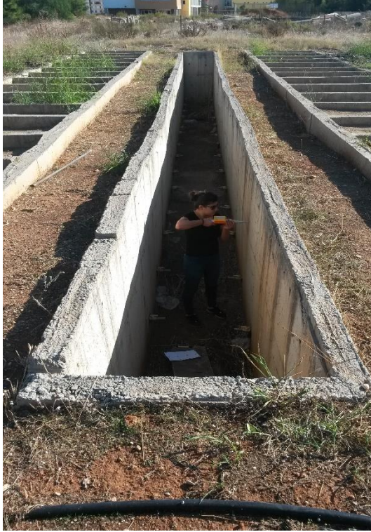
Şekil 4.1. Beton test çekicinin yapı elemanına uygulanması
