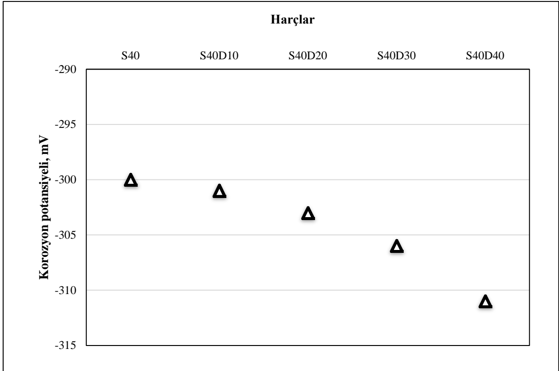
Şekil 4.79. S40D karışım serisi korozyon potansiyeli değerleri
