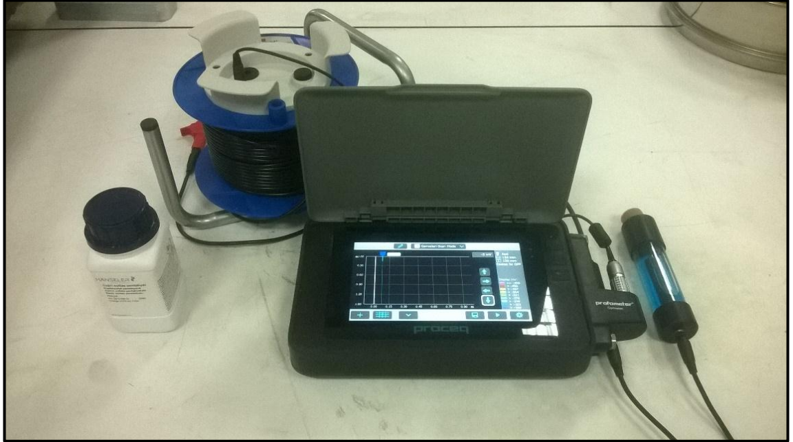
Şekil 3.6. Korozyon ölçüm düzeneği genel görünümü
