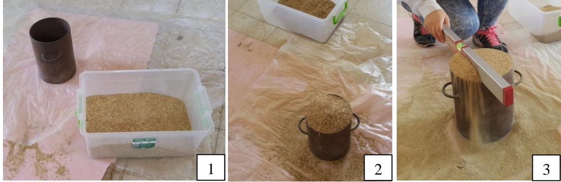
Şekil 3. 15. Yığın yoğunluğu belirleme yolu aşamaları
