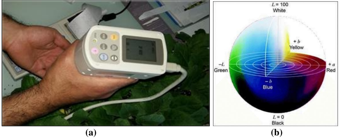
Şekil 3.13. a) Yapraktaki renk ölçümünden bir görünüm; b) a* ve b* renklerinin karşılık geldiği renk diyagramı
