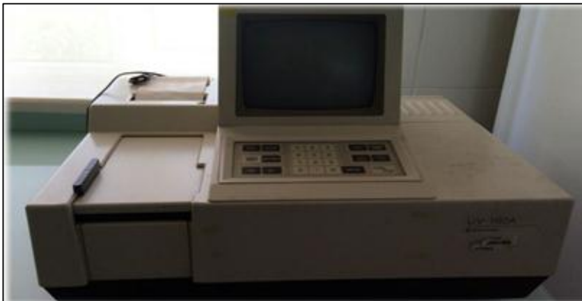
Şekil 3.9. Shimadzu UV-VIS 160 Spektrofotometre cihazından bir görünüm
