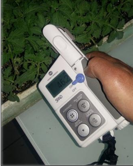
Şekil 3.12. Klorofil miktarı ölçümünden bir görünüm
