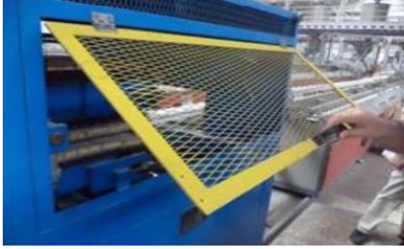
Şekil 2.37. Kilitlemeli makine koruyucuları (Alpsoy 2014)
