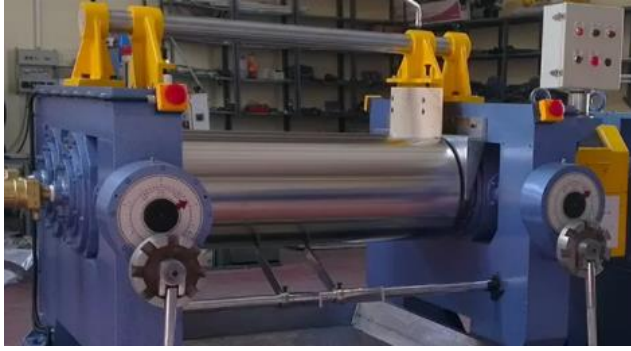
Şekil 2.42. Acil durum durdurma sistemi örneği (Alpsoy 2014)
