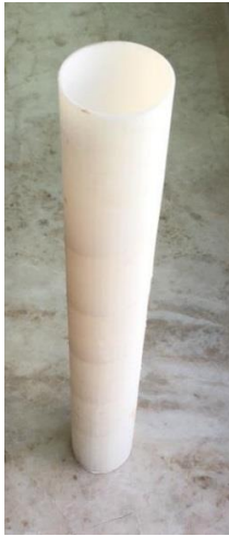
Şekil 3.5. 3D yazıcı kullanılarak imal edilen helezonlu tip tohum borusu
