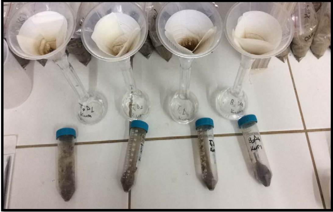
Şekil 3.17. Toprak örneklerinin katyon değişim kapasitesi analizinin yapım aşamalarından bir görüntü
