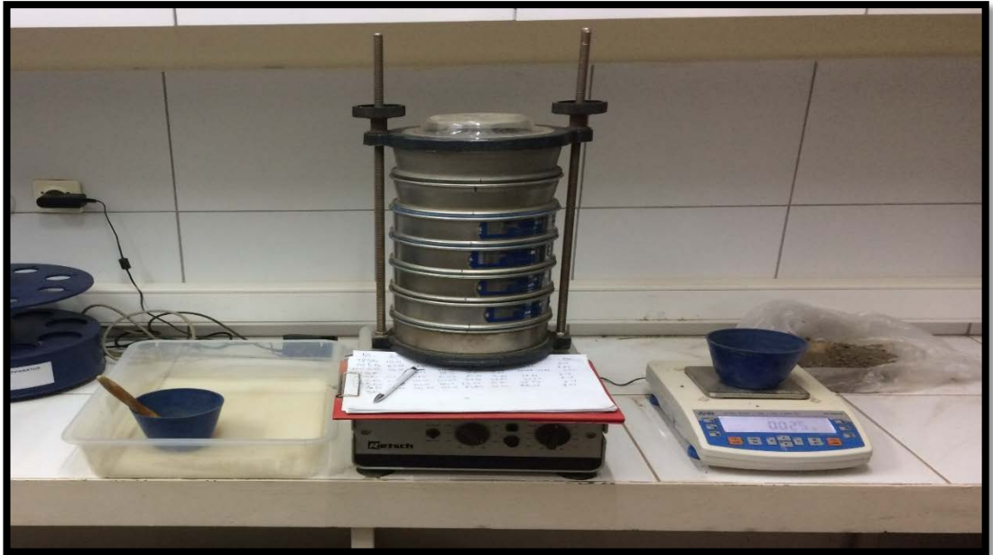
Şekil 3.16. Agregat büyüklük dağılımı analizinde kullanılan Rotar elek takımının görünümü
