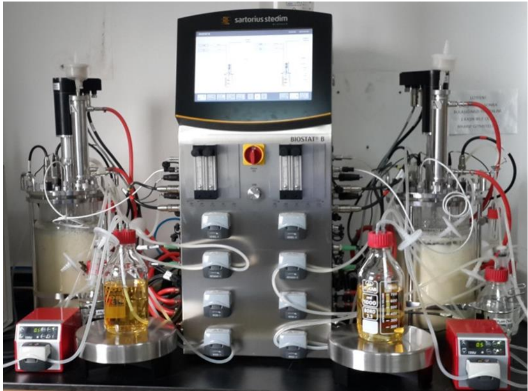
Şekil 3.2. Çalışmadaki yarı-kesikli fermentasyonların gerçekleştirildiği Biostat B Twin (Sartorius Stedim Systems, Almanya) fermentörü genel görünüş
