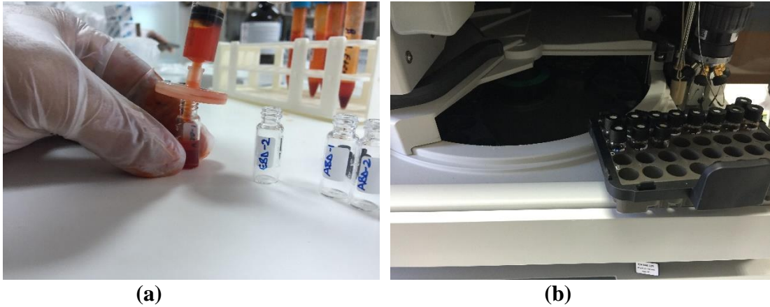
Şekil 3.9. a) Ekstraktların filtrasyonu (0.45 µm membran filtre); b) Viallerin oto örnekleyiciye yerleştirilmesi
