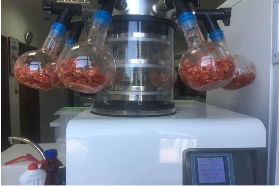
Şekil 3.3. Dondurarak kurutucuda karides işleme artıklarının kurutulması
