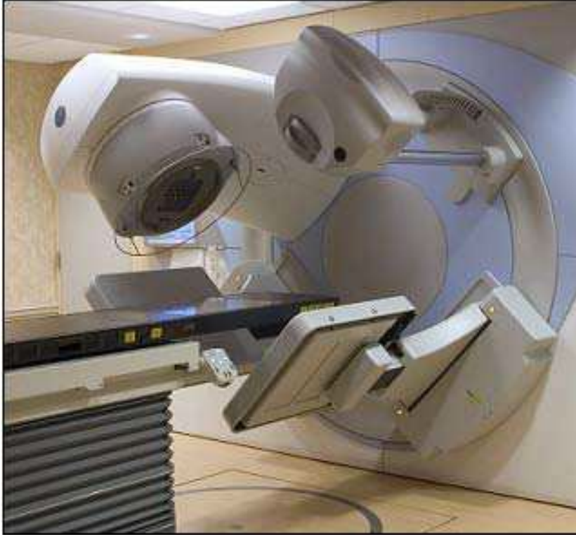
Şekil 2.12. kV görüntüleme sistemleri ve XVI ile Elekta Synergy® Lineer Hızlandırıcı
