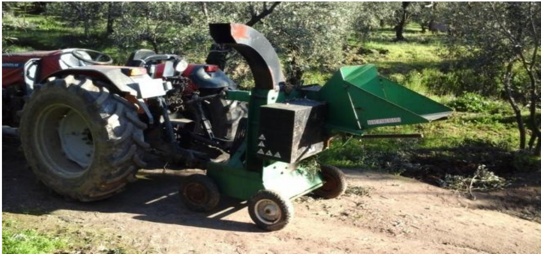
Şekil 4.18. Kuyruk milinden hareketli budama atığı parçalama makinası
