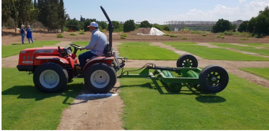
Şekil 4.2. Trafik denemesi çalışması başlatıldıktan 2 hafta sonra trafik stresi Brinkman trafik simülatörü uygulaması.
