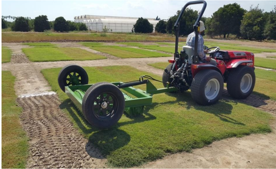
Şekil 3.3. Trafik stresi uygulamasında kullanılan Brinkman trafik simulatörü (BTS) (Cockerham and Brinkman, 1989)
